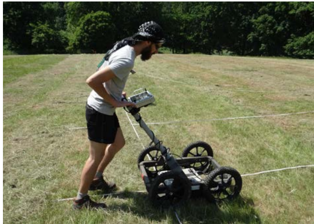
Badanie georadarowe w Dolinie Śmierci (fot. D. Kobiółka).
